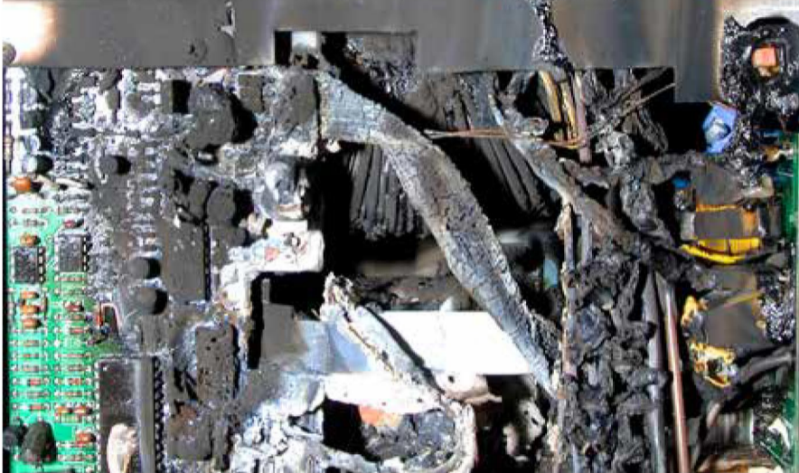
Den brända enheten, full av smält plast.
